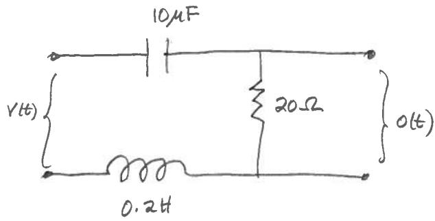
$$V(\omega) - \frac{I(\omega)}{-i\omega C} - RI(\omega) - L(-i\omega)I =$$
