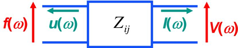
$$\begin{bmatrix} f(\omega) \\ V(\omega) \end{bmatrix} = \begin{bmatrix} Z_{11} & Z_{12} \\ Z_{21} & Z_{22} \end{bmatrix} \begin{bmatrix} u(\omega) \\ I(\omega) \end{bmatrix}$$
