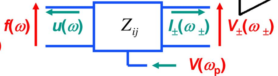
$$\begin{bmatrix} V_-^*(\omega_-) \\ f_1(\omega) \\ V_+(\omega_+) \end{bmatrix} = \begin{bmatrix} Z_{--}^* & Z_{-1}^* & 0 \\ Z_{1-} & Z_{11} & Z_{1+} \\ 0 & Z_{+1} & Z_{++} \end{bmatrix} \begin{bmatrix} I_-^*(\omega_-) \\ u_1(\omega) \\ I_+(\omega_+) \end{bmatrix}$$
